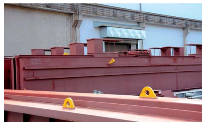
Díly elektrofiltru - střešní nosníky
