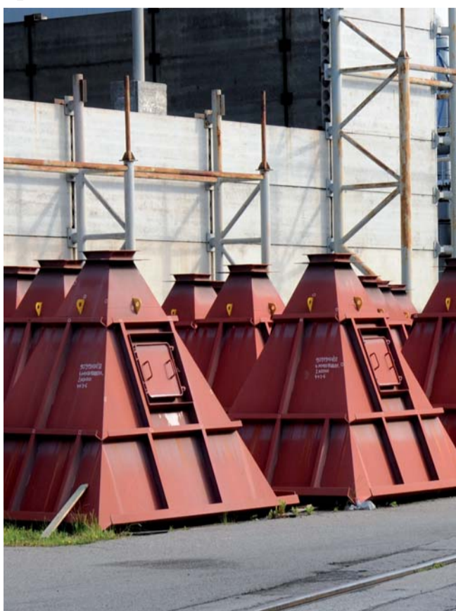
Díly elektrofiltru - části výsypek
