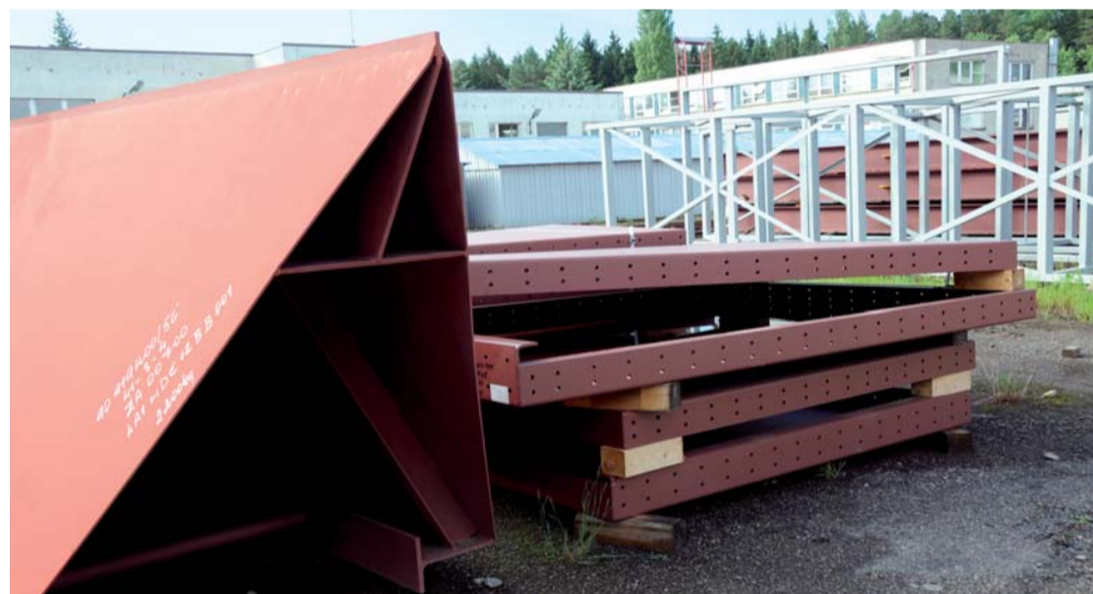
Díly elektrofiltru - části výsypek
