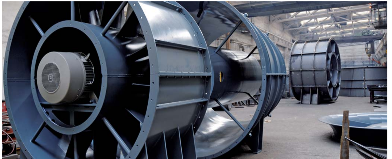
Ventilátory pro pražský silniční tunel Blanka
