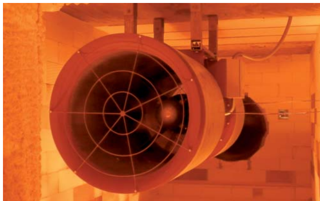
Ventilátor APWT 1000 / 1500min-1 umístěný v peci při zkoušce
