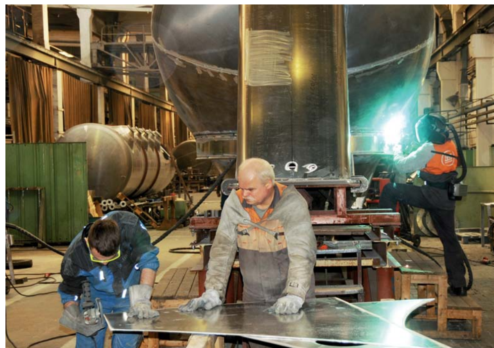
Jakub Pinc a Michal Verba při úpravě plechů na sestavení nádoby s rámem (návěs NCG 40). V pozadí svařeč Tomáš Frydrych.
