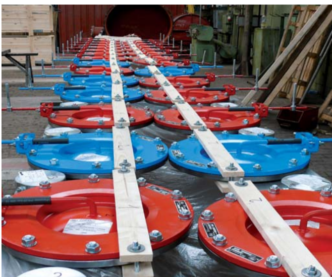
Přetlakové a hermetické klapky pro jadernou energetiku.
