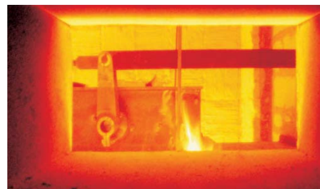
Klapka v peci při maximální teplotě.
