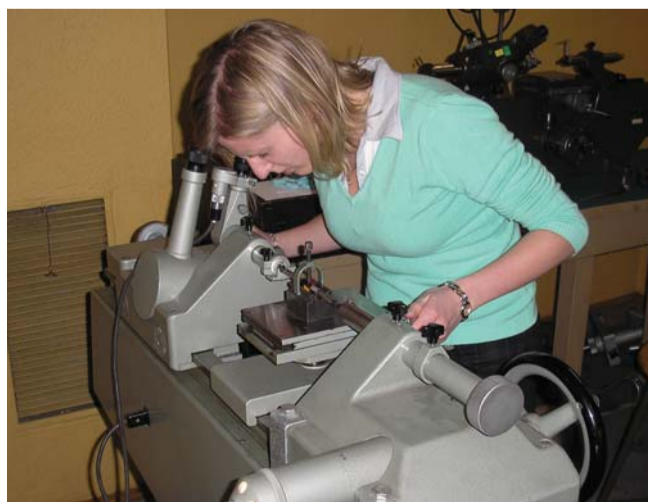
Ing. Jana Mlezivová při měření pevného odpichu na měřiči ULM 3000
